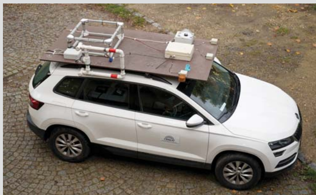
Měření neprovádíme jenom na horských stanicích, ale i v autech. Auto je vybaveno anténami pro detekci blesků, vysokorychlostní kamerou, elektrickým mlýnkem pro měření el. pole a gama spektrometrem. Foto: Jakub Kákona
