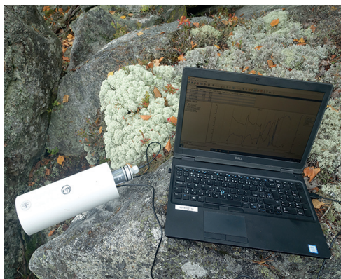
Obr. 3. Stahování dat pomocí Optic USB Base Station (BASE-U-4), foto: M. Zuna.
