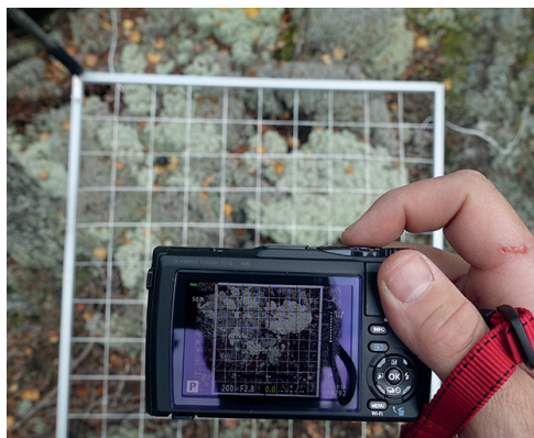
Obr. 4. Fotografování TMP s přesnou paralelní projekcí s monitorovací mřížkou, foto: M. Zuna.
