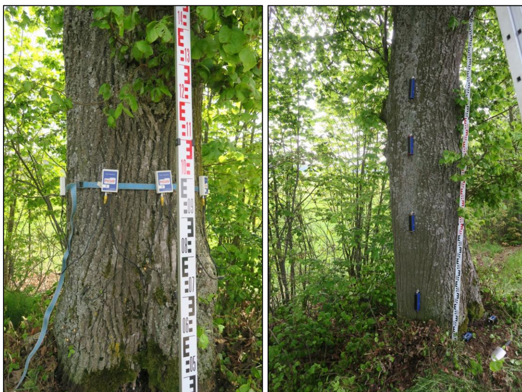
Obrázek 54 Přístrojové hodnocení stromů v Bukovské aleji.
